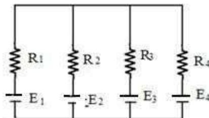
$$\frac{E_1 G_1 + E_2 G_2 + E_3 G_3 + \dots}{G_1 + G_2 + G_3 + \dots}$$
